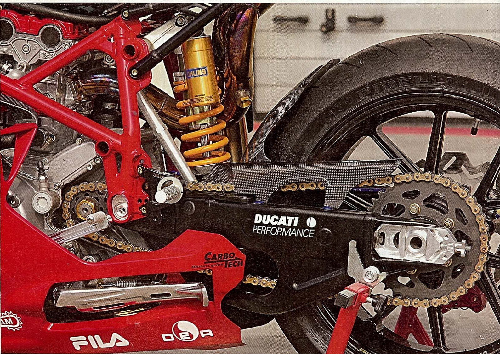
Am Federbein wurde lediglich die Feder gegen ein härteres Pendant ausgetauscht. Die Fußrasten sind einstellbar, das Schaltschema wurde umgedreht
