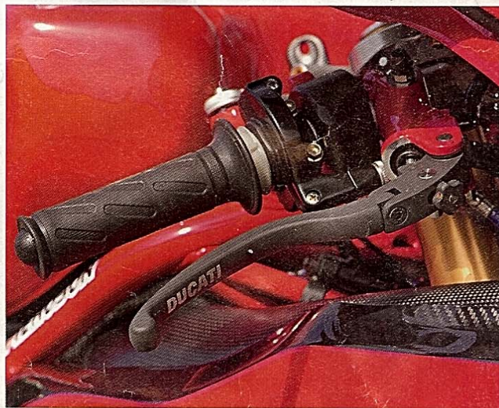
Wir wollen's nicht probieren: Sturzresistenter Klapp-Bremshebel
